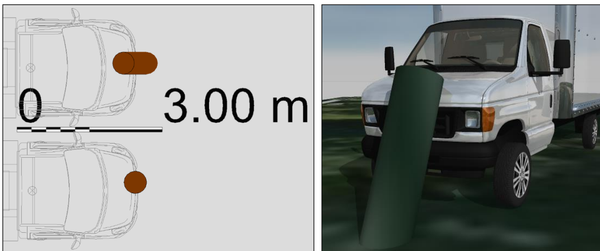
Obr. 9: Korepondence poškození vozidla s předmětným stromem [znalec]
