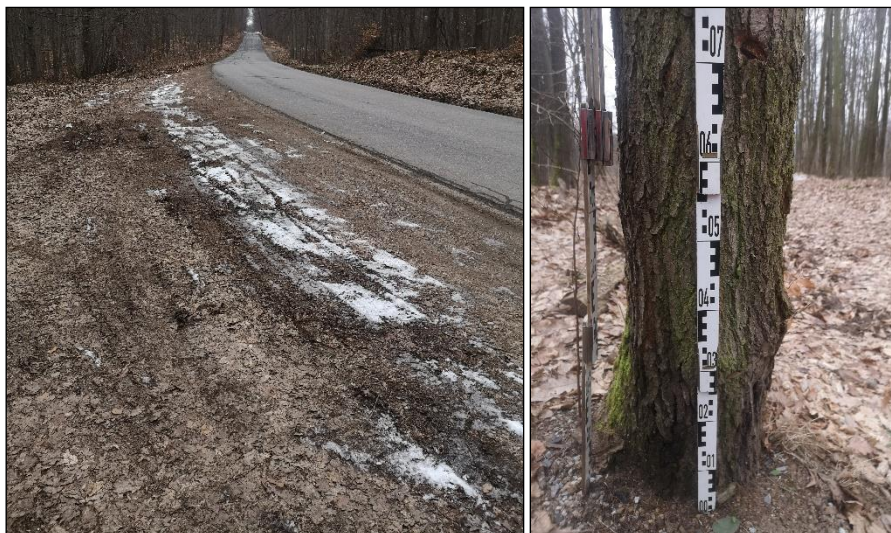
Obr. 7: Terén v místě výjezdu vozidla mimo komunikaci plocha u vrcholu směrového oblouku přilehlá ke komunikaci (obr. vlevo), detail tvaru kmene stromu ve výšce 0 až 70 cm nad terénem (obr. vpravo) [zdroj znalec]
