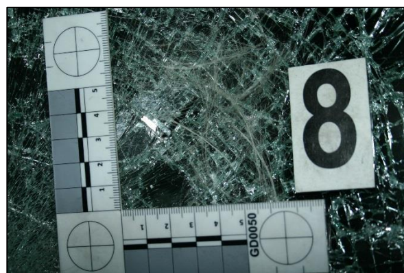
Obr. 5: Detail vlasů chodce zachycených v čelním skle vozidla [Zdroj PČR]
