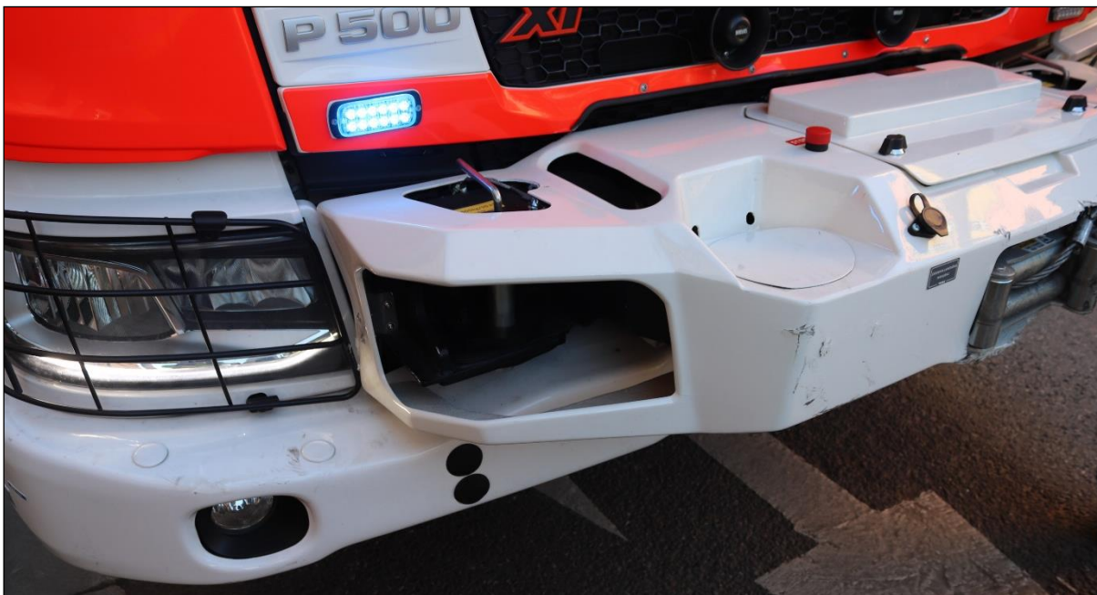
Obr. 14: Poškození rámu navijáku vozidla Scania na pravé straně [zdroj PČR]
