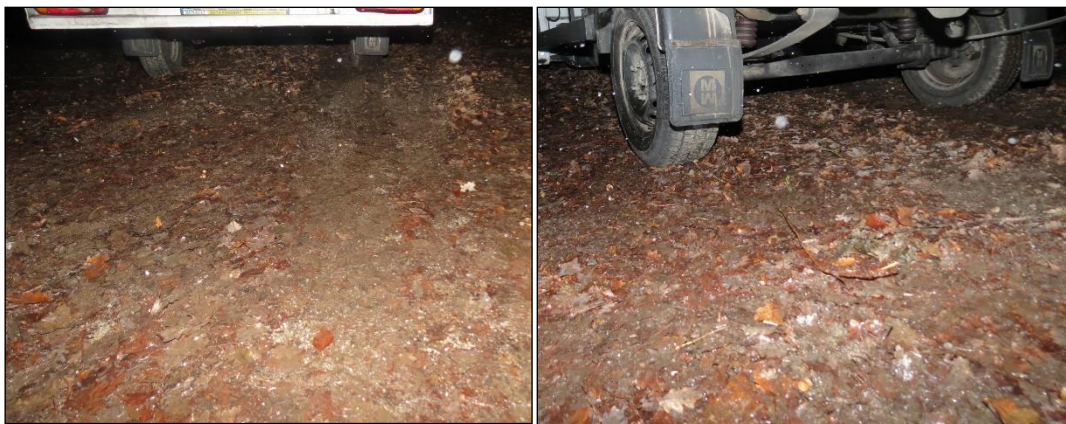
Obr. 5: Detail stop za vozidlem, absentují brzdné stopy, čistý dezén [zdroj PČR]
