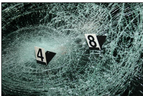
Obr. 4: Detail poškození čelního skla vozidla [Zdroj PČR]
