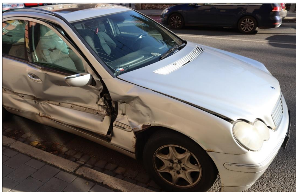
Obr. 11: Poškození vozidla Mercedes, detail místa největší deformace [zdroj PČR]
