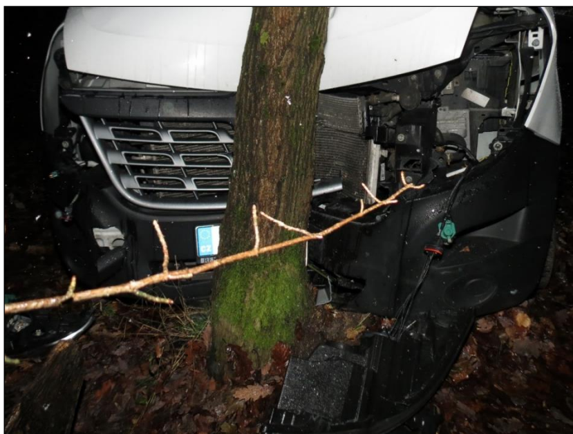
Obr. 3: Vozidlo v konečné poloze po nárazu, vypadnutý pravý světlomet, plasty blízko stromu [zdroj PČR]
