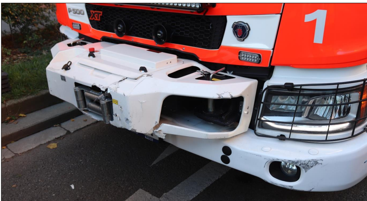
Obr. 15: Poškození rámu navijáku vozidla Scania na levé straně a poškození nárazníku [zdroj PČR]
