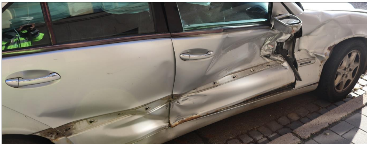
Obr. 10: Poškození vozidla Mercedes, celá kontaktní oblast s vozidlem Scania [zdroj PČR]
